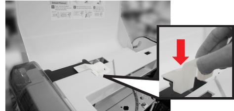
3 Repositionnez le dispositif de maintien et appuyez dessus pour qu'il s'insère dans la fente.
