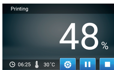
5. モニターは印刷の完成度を表示します。下はフィラメントの補充、一時停止、印刷の取消機能があります。
