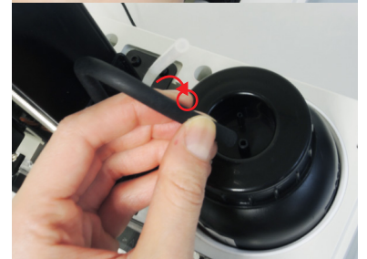
⑪ 分別將注料管壓到底，先將粗口徑黑管接到大孔，再將小口徑透明管接到小孔
