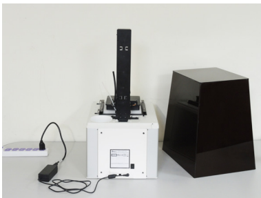
② 將電源轉換器、電源線互相連接並接上列印機後，將電源插入插座
