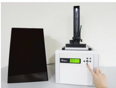
④ 升起列印平臺： 在列印機上選取「UTILITIES」(功能操作)，然後按▶找到「MOVE PLATFORM」(移動列印平臺)功能，然後選擇「TO TOP」(移至上方)
