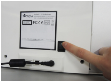
③ 按下電源開關，開機後請等待列印機自我檢測約10分鐘
